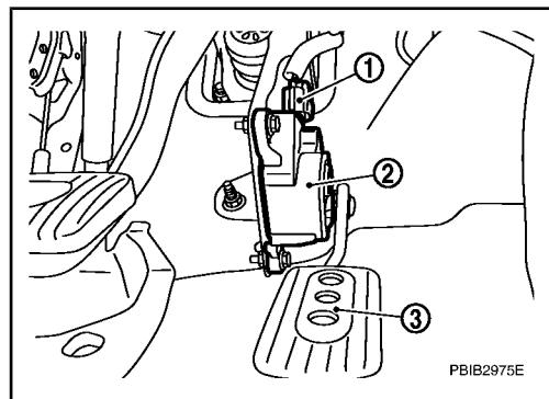
3. 使用诊断仪或测试仪，测量加速踏板位置传感器端口 5 与接地之间的电压。
